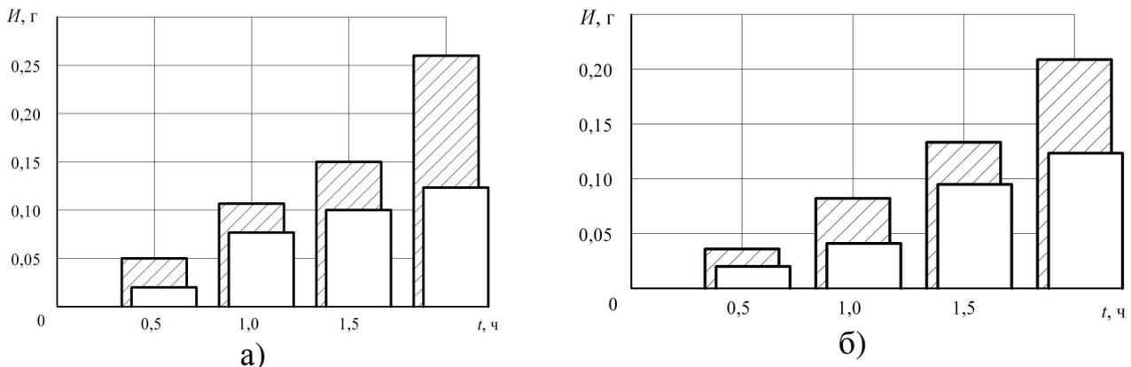
Рис. 2. Диаграммы износа колодочки –и ролика – при: а) обычном и б – вибрационном деформировании
