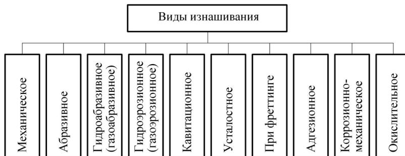
Рис. 3. Классификация процессов изнашивания
