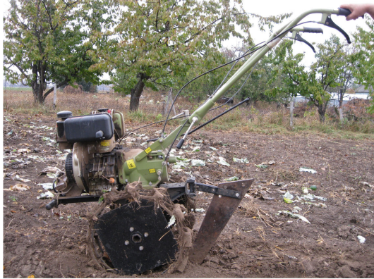
Рис.2. Ґрунтообробний агрегат в складі запропонованого робочого органу та мотоблоку ZIRKA IZ 105
