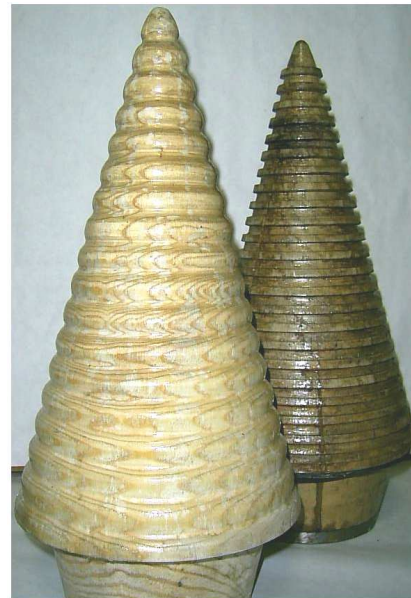
Рис. 3. Профільовані поверхні, на яких формується плівкова течія
