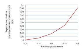
Рис. 4. Зависимость вероятности ошибки декодирования отдельно взятого бита от величины амплитуды аддитивной помехи
