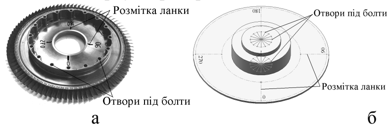
Рис. 2. Розмітка ланки ротора КВТ ГТД з отворами під болти: а – фотографія; б – 3D модель
