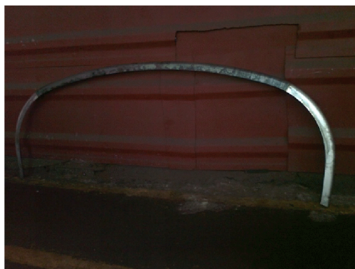
Рис. 3 – Дуга пассажирского вагона из разнородных металлов после гибки с растяжением
