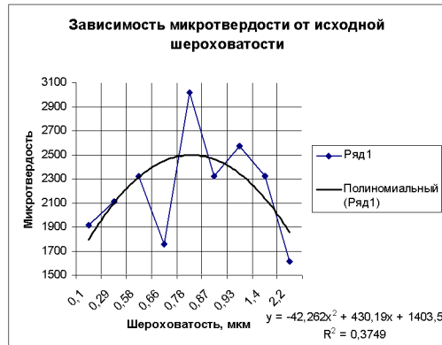
Рис 2. - Зависимость микротвердости от исходной шероховатости обрабатываемой поверхности
