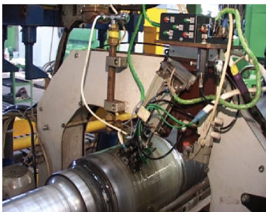
Рис. 2 – Установка для контактного ультразвукового контроля объема металла заготовок железнодорожных осей
