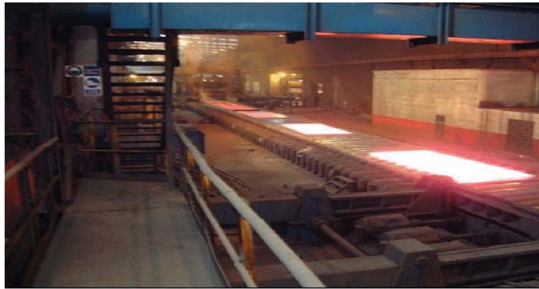
Рис. 2 – Контролируемая прокатка с выдержкой раскатов на рольганге (по материалам технической конференции г. Краков, март 2005г.)
