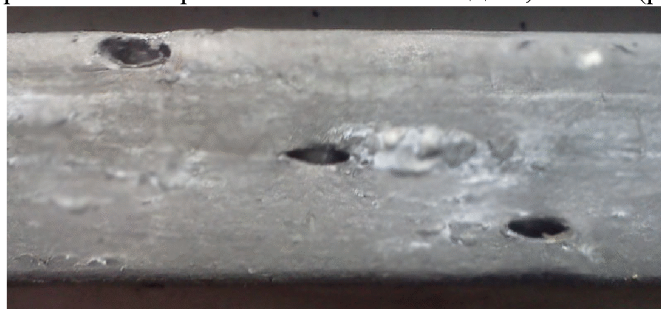
Рис. 2 – Вид деформированных пор на боковой поверхности ( \epsilon=25\% )
