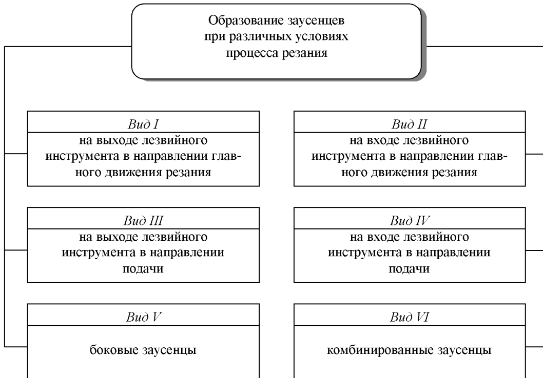
Рис. 3 – Классификация видов заусенцев в различных условиях процесса резания
