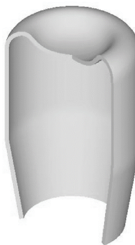
Рис. 5 – Загальний вигляд виробу в розрізі після традиційного обтиску
