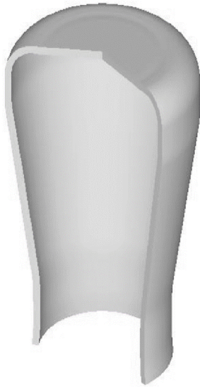
Рис. 9 – Загальний вигляд виробу в розрізі після обтиску з протитиском
