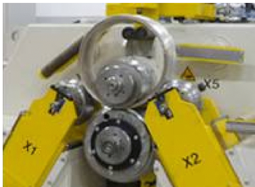
Рис. 2 – Профілювання обода с нажимним пристроєм
