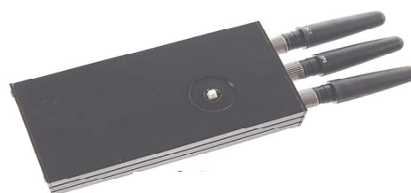
Рис. – Пристрій генерації шуму 800-2100Mhz
