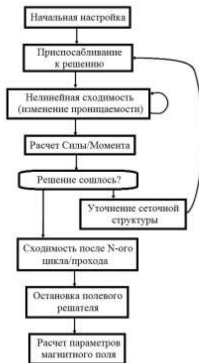
Рис. 3 - Алгоритм статической задачи полевого решателя в Maxwell 3D
