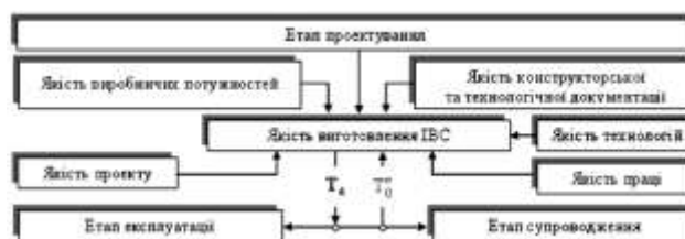
Рис. 3 - Структура показників якості етапу виробництва ІВС, де: T_4 – множина значень показників якості виготовлення (виробництва); T_0' – зворотний зв'язок за показниками якості між етапами експлуатації (супроводу) та виробництва; T_3 – множина значень вихідних показників якості
