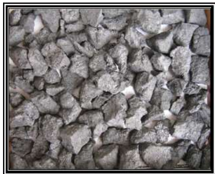
Рис. 1 – Вид зверху шару коксу промислового гранулометричного складу обмеженої площі з жорсткими границями
