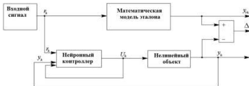
Рис. 3 – Схема включения нейроконтроллера в систему [9]
