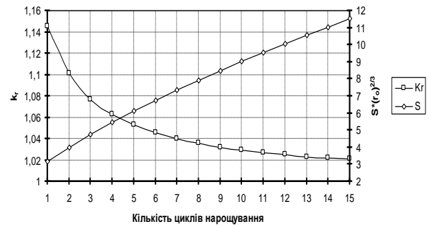
Рис. 2 – Зміна величини коефіцієнту приросту радіусу часток магнетиту ( kr ) та площі поперечного перерізу пор ( S ) від кількості циклів нарощування
