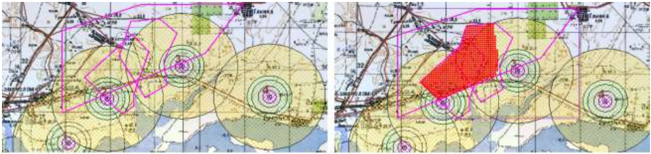
Рис. 5 – Побудова інтегральних зон шуму з урахуванням дії трьох локальних факторів: а – діапазон зон шуму для кожної з чотирьох ВЕУ при початковому розміщенні; б – інтегральна зона шуму
