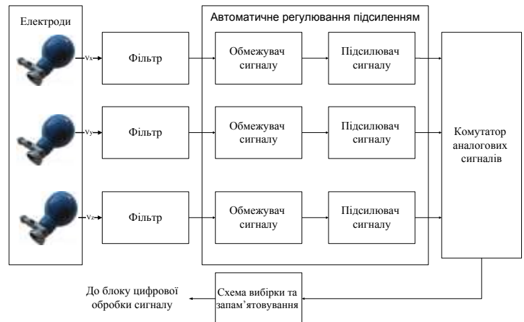
Рис. 4. Структурна схема блоку аналогової обробки сигналу
