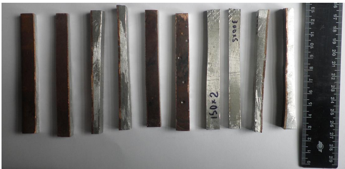
Рис. 2 – Внешний вид образцов для растяжения
