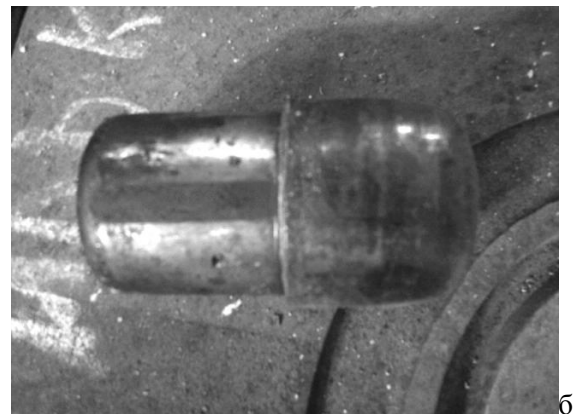
Рис. 2 – Количественная оценка причин входа из строя молотовых штампов: а – гистограмма поломок; б – шпилька, выпавшая из гнезда штампа
