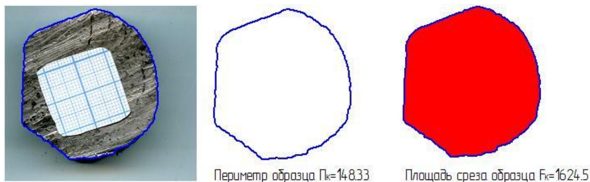
Рис. 5 – Пример сканирования темплета для образца «3» и определения его геометрических характеристик
