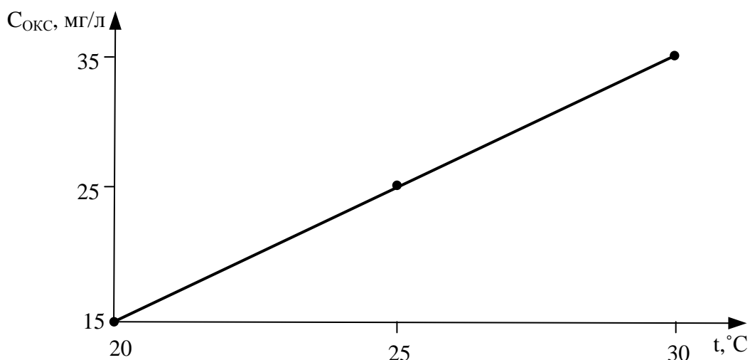
Рис. 4 – Зависимость концентрации озона в ОКС, необходимой для поддержания заданного значения концентрации озона в ОФР, от температуры окружающей среды
