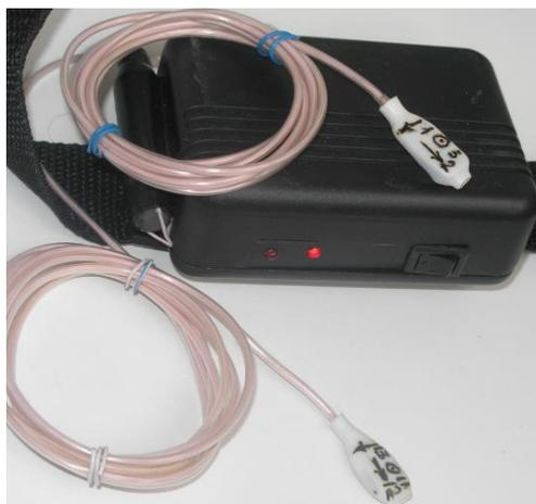
Рис. 2 – Измерительный прибор для исследования ускорений
