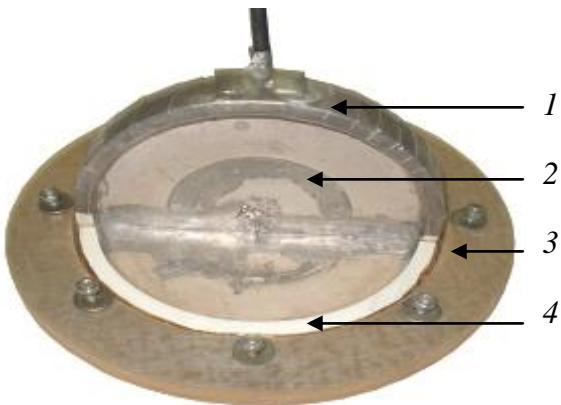
Рис. 2 – Внешний вид исходного ИЭА.: 1-закоротка резонатора; 2-резонатор; 3- кольцо крепления к фантуму пациента; 4-излучающий лепесток
