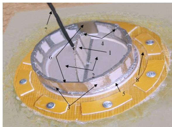
Рис. 1 – Вид экспериментального образца перспективного ИЭА со стороны резонаторов: 1 – возбуждающий резонатор. 2 – излучательные лепестки. 3 – дополнительный резонатор. 4 – замыкающие перемычки. 5 – экранирующее покрытие торца излучательных лепестков. 6 – технологические стеклотекстолитовые грани. 7 – фидер электромагнитного питания. 8 – кольцо крепления ИЭА к фанту
