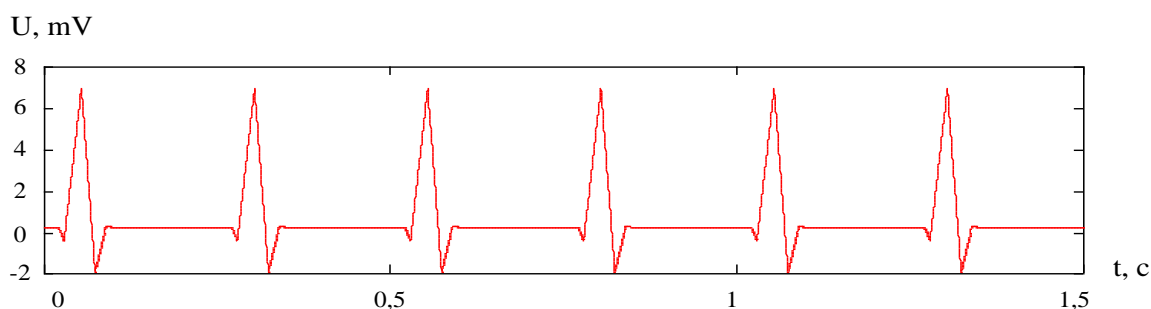
Рис. 7 – Последовательность QRS-комплексов без влияния помех
