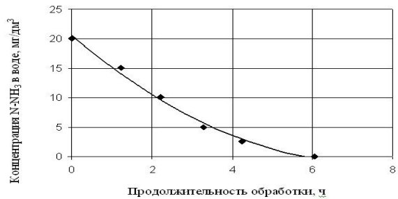
Рис. 6 – Влияние продолжительности обработки на концентрацию NH 3 в воде
