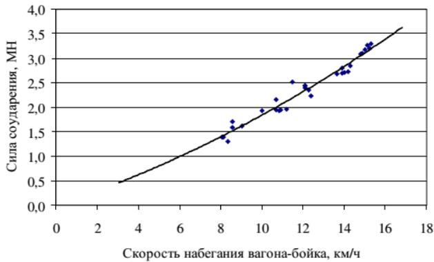
Рис. 15 – Зависимость силы соударения от скорости набегания вагона-бойка
