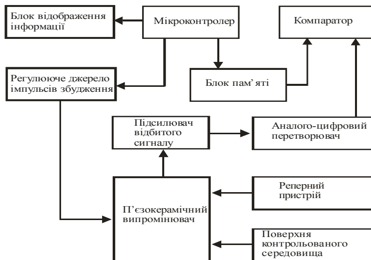
Рис. 1. Структурна схема компенсаційного ультразвукового рівнеміра
