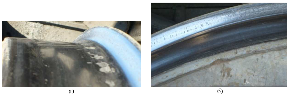
Рис. 2 – Фрагменты состояния колесных пар: а) – изменение диаметра колеса, б) – выщербленность
