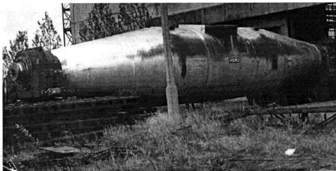
Рис. 2 Миксер передвижной МП - 600 АС ёмкостью 600 т расплавленного металла
