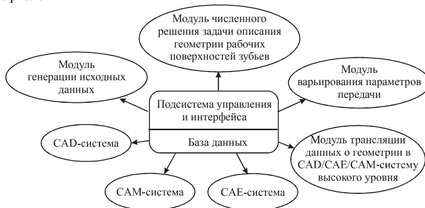
Рис. 1. Структура системы автоматизированного моделирования формы рабочих поверхностей зубьев двухпараметрических передач
