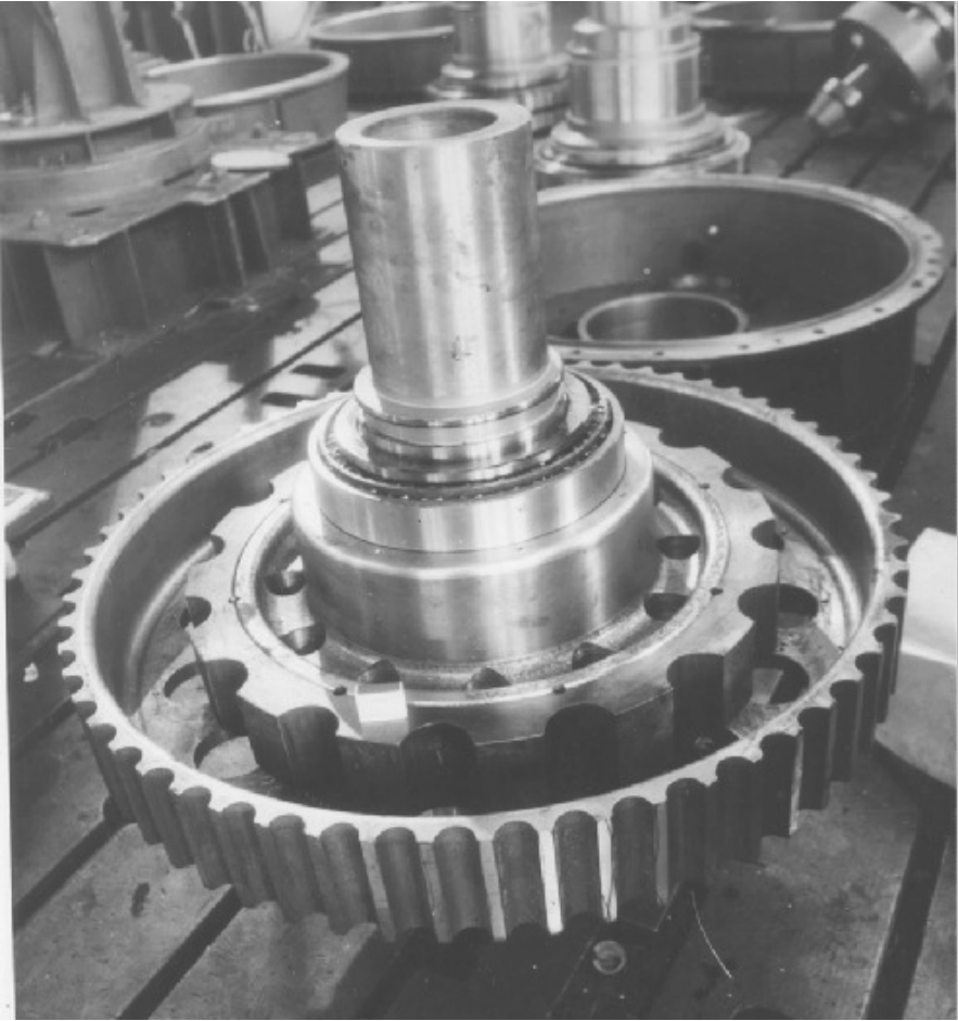
Рис. 3. Сателлит для передачи с промежуточными телами качения
