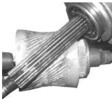
Рис. 4 Процесс генерирования зубьев квазигиперboloидной зубчатой передачи
