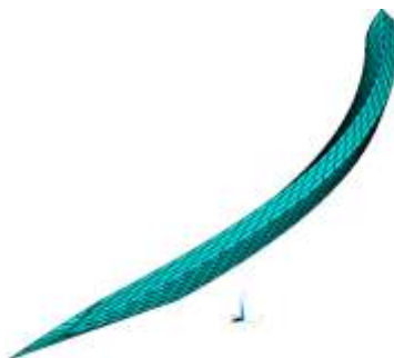
Рис. 6. Топологически регулярная КЭМ зуба конического колеса
