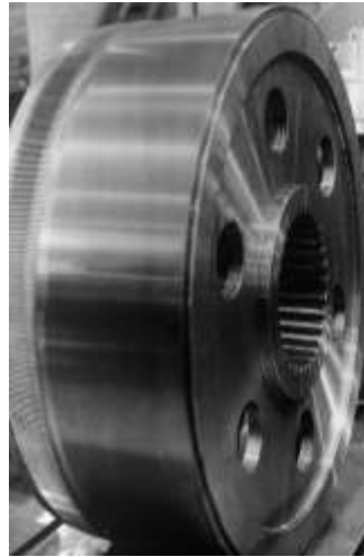
Рис. 7 Гибкое колесо в сборе волнового редуктора механического привода рудоразмольной мельницы МГР 5500x7500
