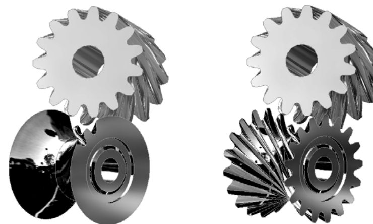
Рис. 7. Процесс накатывания зубьев
