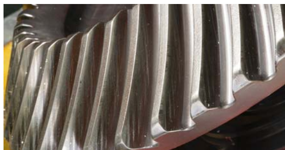
Рисунок 5 – Состояние зубчатых колес с цементированными зубьями
