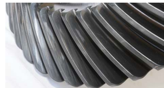
Рисунок 4 – Состояние зубчатых колес с ионно-плазменным азотированием
