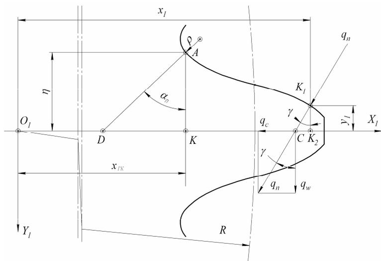
Рисунок 2 – Схема зуба колеса
