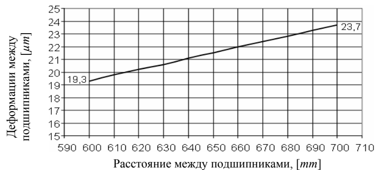
Рисунок 11 – Деформации в шпинделе между опорами при внешней нагрузке 10000 [N]
