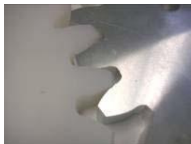
Рисунок 7 – Оброблене евольвентне зубчасте зачеплення
