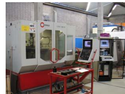
Рисунок 2 – Експериментальний стенд на базі оброблювального центру
