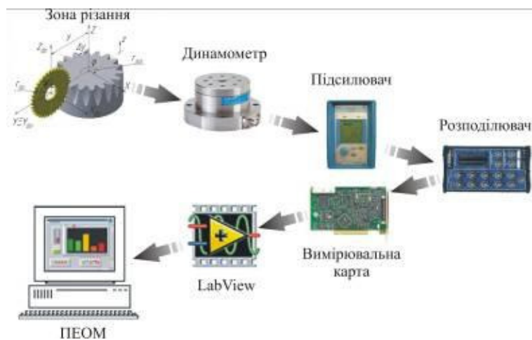
Рисунок 5 – Принципова схема вимірювання складових сили різання
