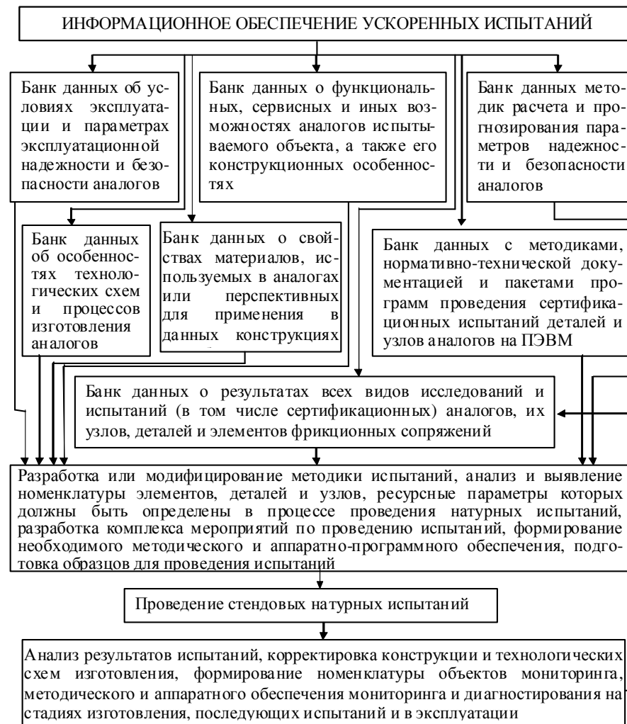
Рисунок 4 – Схема информационного обеспечения подготовки, проведения и обработки результатов ускоренных испытаний
