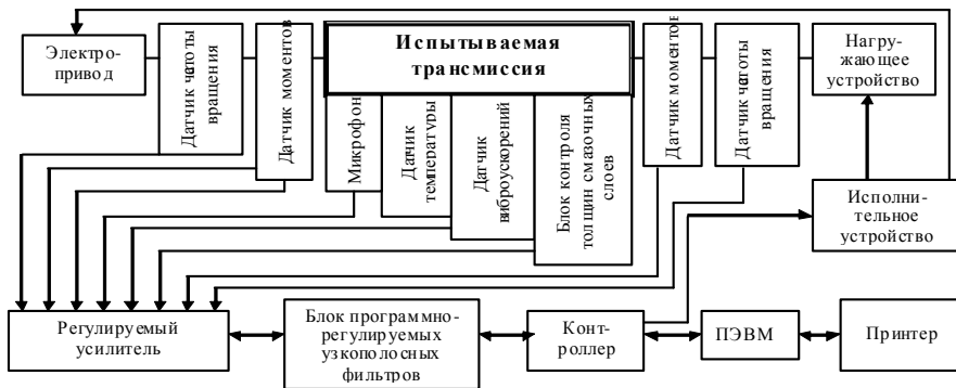
Рисунок 5 – Схема станционного комплекса для проведения ускоренных испытаний и контроля качества изготовления и сборки многоступенчатых трансмиссий на основе зубчатых передач
