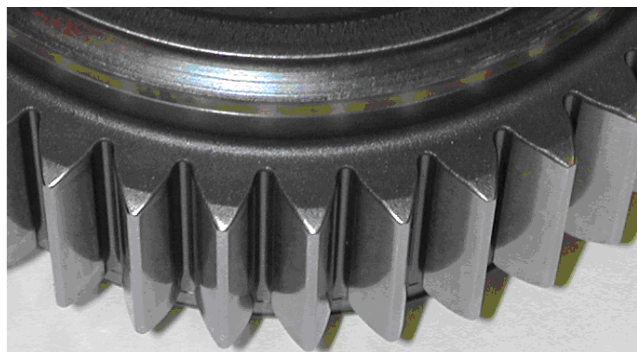
Рисунок 2 – Зубья колеса с несимметричными профилями: основной профиль 33^\circ , направляющий 25^\circ
