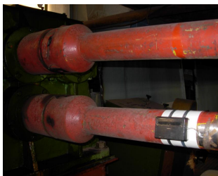
Рисунок 10 – Телеметрический измеритель моментов, установленный на нижнем шпинделе прокатного стана
