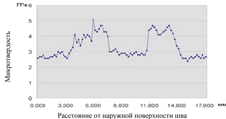
Рисунок 5 – Микротвёрдость на расстоянии 2мм от верхней поверхности сварного шва стали 30ХГСА [2]
