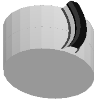
Рисунок 4 – Арочный зуб с циклоидальной формой
