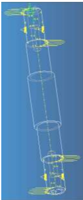
Рисунок 5 – Форма и нагрузка на вал №3
