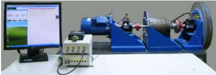
Рисунок 4 – Стенд для испытания механических передач
